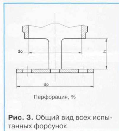
Рис. 3. Общий вид всех испытанных форсунок
